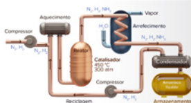
Diagrama do processo de produção industrial do amoníaco.
